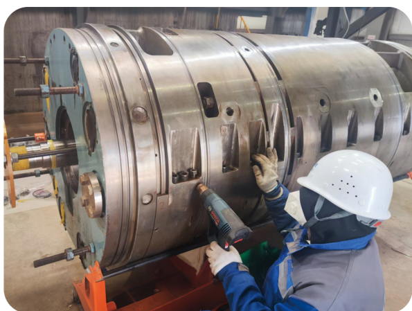
LNG MRC Compressor Overhaul
