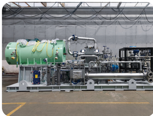
石化PTA反应器进料泵撬装
