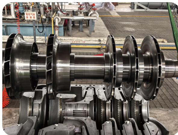
甲醇合成气压缩机大修
